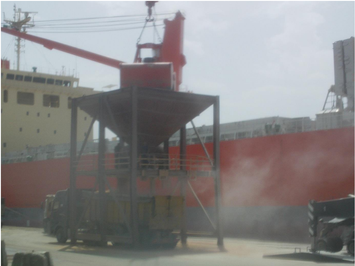
Photo n°15 –Engin facilitant l’acheminement des céréales vers le camion-
