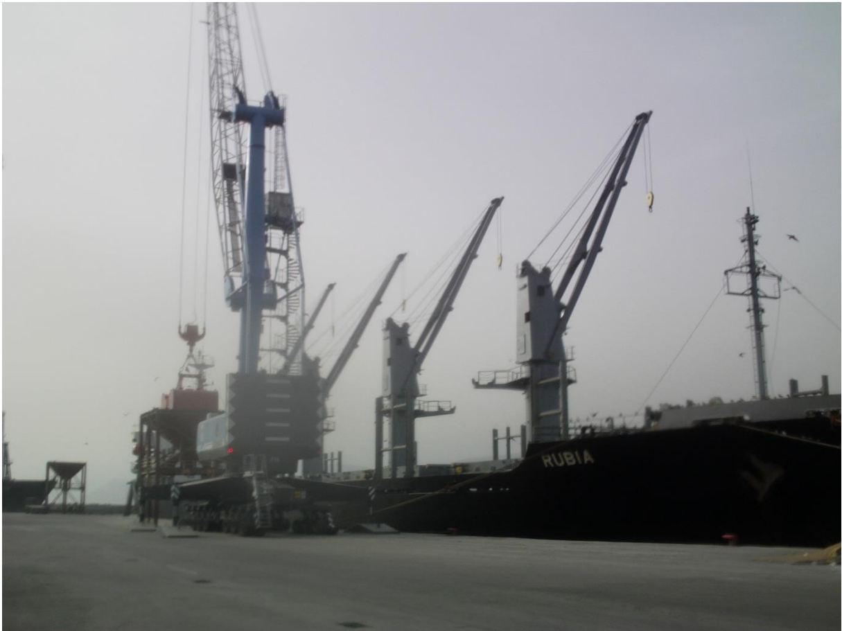
Photo n°5 – Grue servant à déplacer la marchandise du navire vers des camions-
