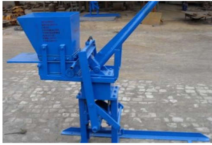
Fig. 3.1 - Dispositif manuel pour façonner de la brique.
