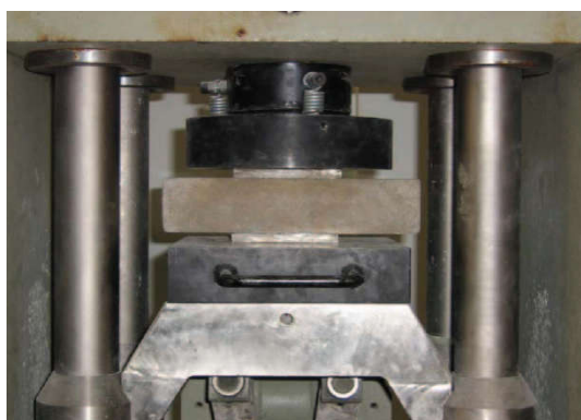
Fig. 4.9 - Le bloc après écrasement
