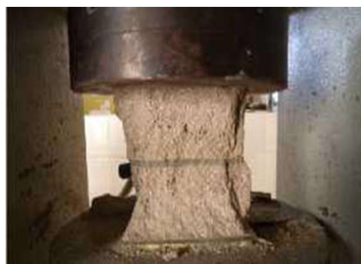
Fig. 4.9 - Le bloc après écrasement
