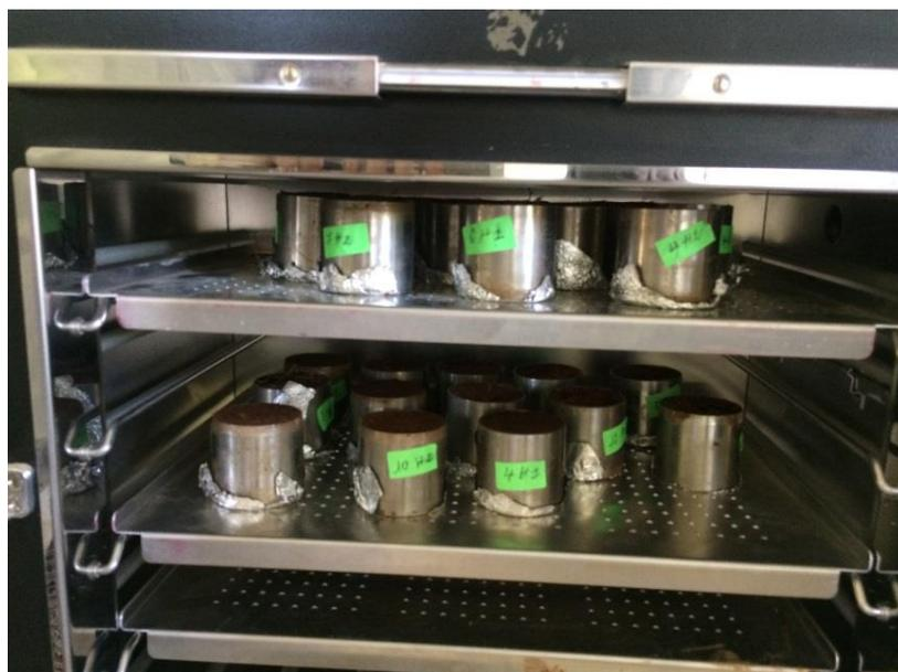
**Figure 9** - Séchage des échantillons dans à l'étuve
