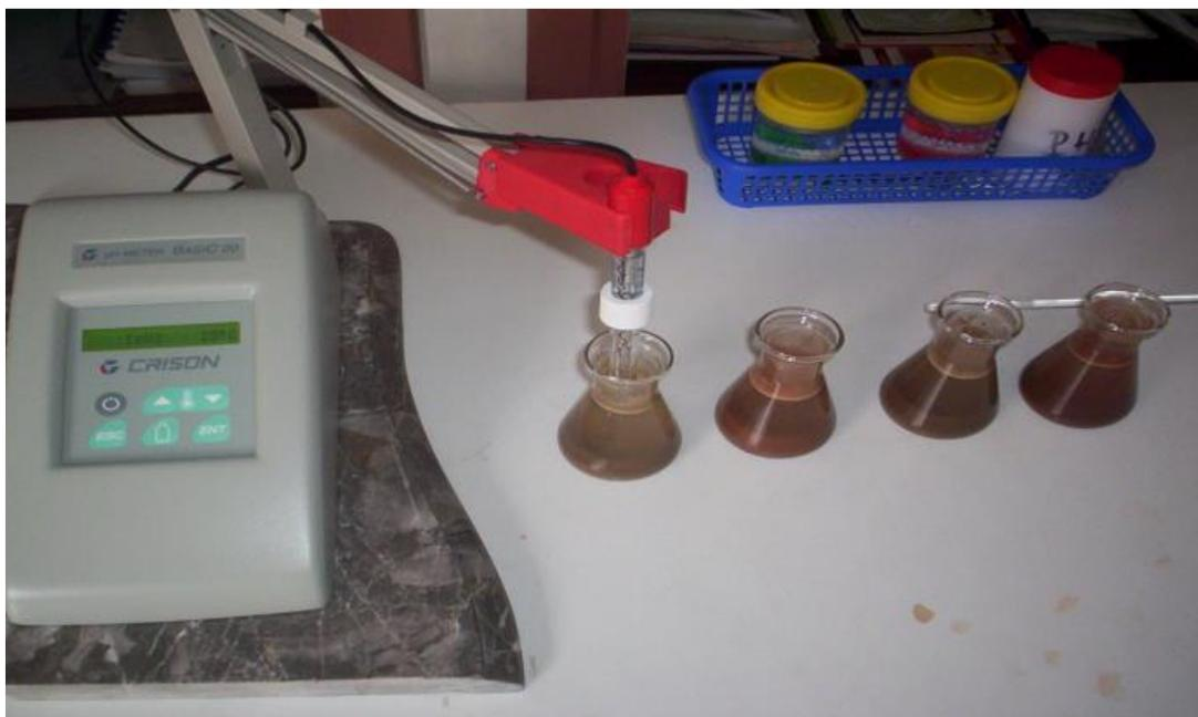
**Figure 14 -** Mesure du pH du sol à l'aide de pH-mètre.
