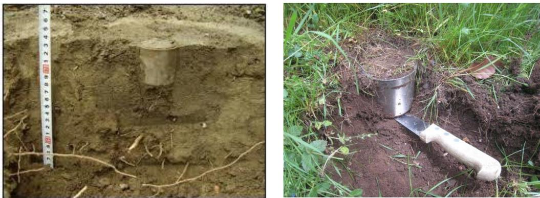
**Figure 7** - Cylindre de la densité apparente
