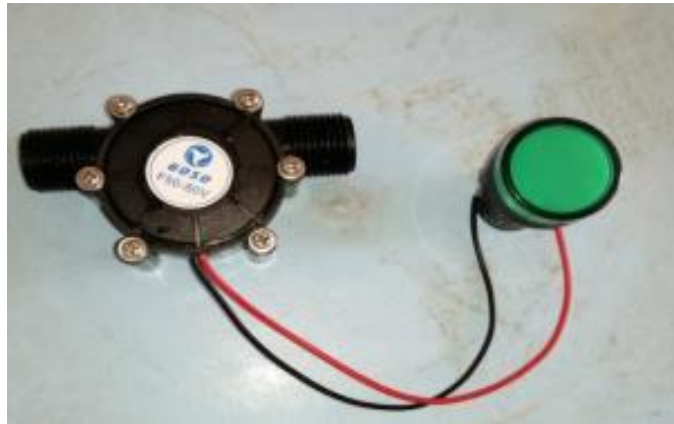
Fig49 : Mini-turbine avec une lampe.
