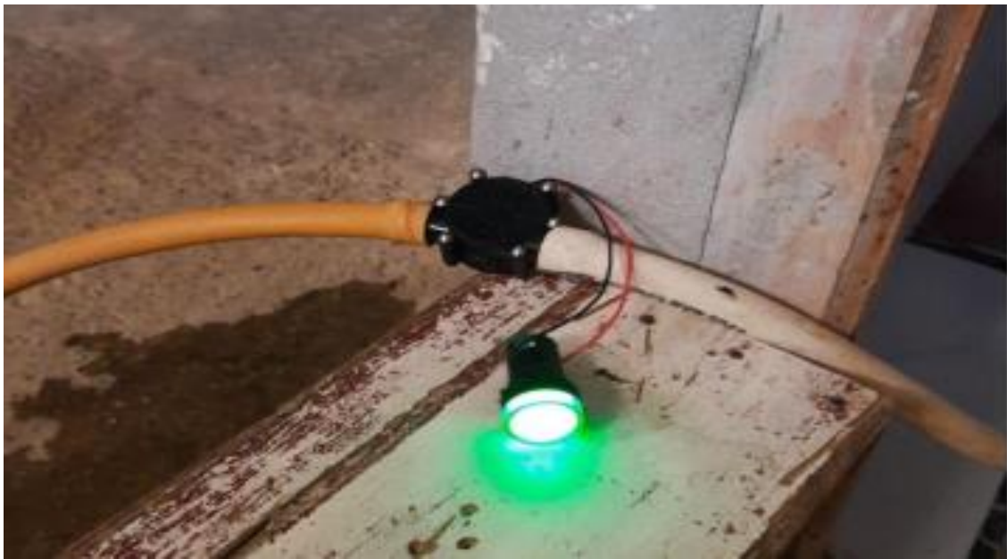
Fig53 : une lampe allumée par la turbine.
