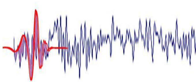
Fig. II.12–Ondelette mère (en rouge) convoluée avec un signal temporel (couleur bleu).
