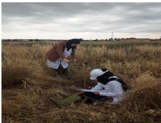
Réaliser des trous a la profondeur 60 cm avec le terrière
