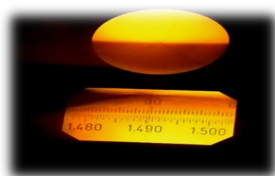
Figure 7: Résultat de la mesure de l'indice de refraction du miel (réfractomètre manuel Abbe)
