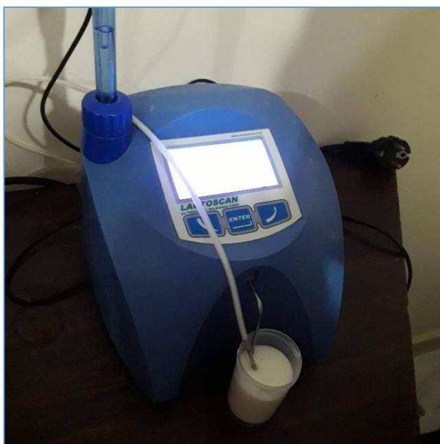
**Figure 7.** Mesure de la teneur en MG par le Lactoscan.
