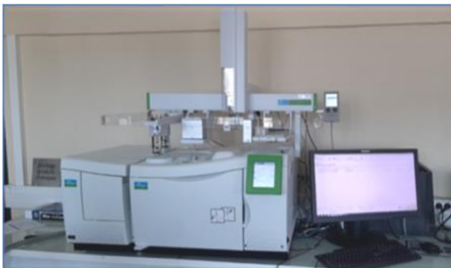
Figure 31 : Chromatographe en phase gazeuse de type Clarus 690 SQ8T GC-MS (Originale)
