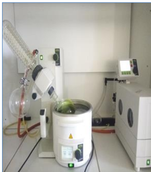
Figure 30 : Rotavapor utilisé pour éliminer le solvant extractant (BUCHE R-210) (Originale)
