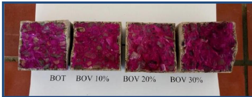
**Figure 2. 35-** Carbonatation naturelle à 12 mois (Safer,O. 2017).
