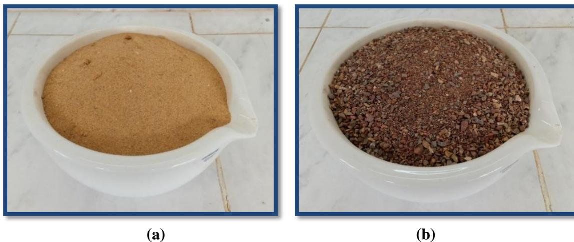
**Figure 4. 6-** Sables utilisés : (a) sable alluvionnaire d'Oued el Kheir, (b) Sable concassé de Terga.
