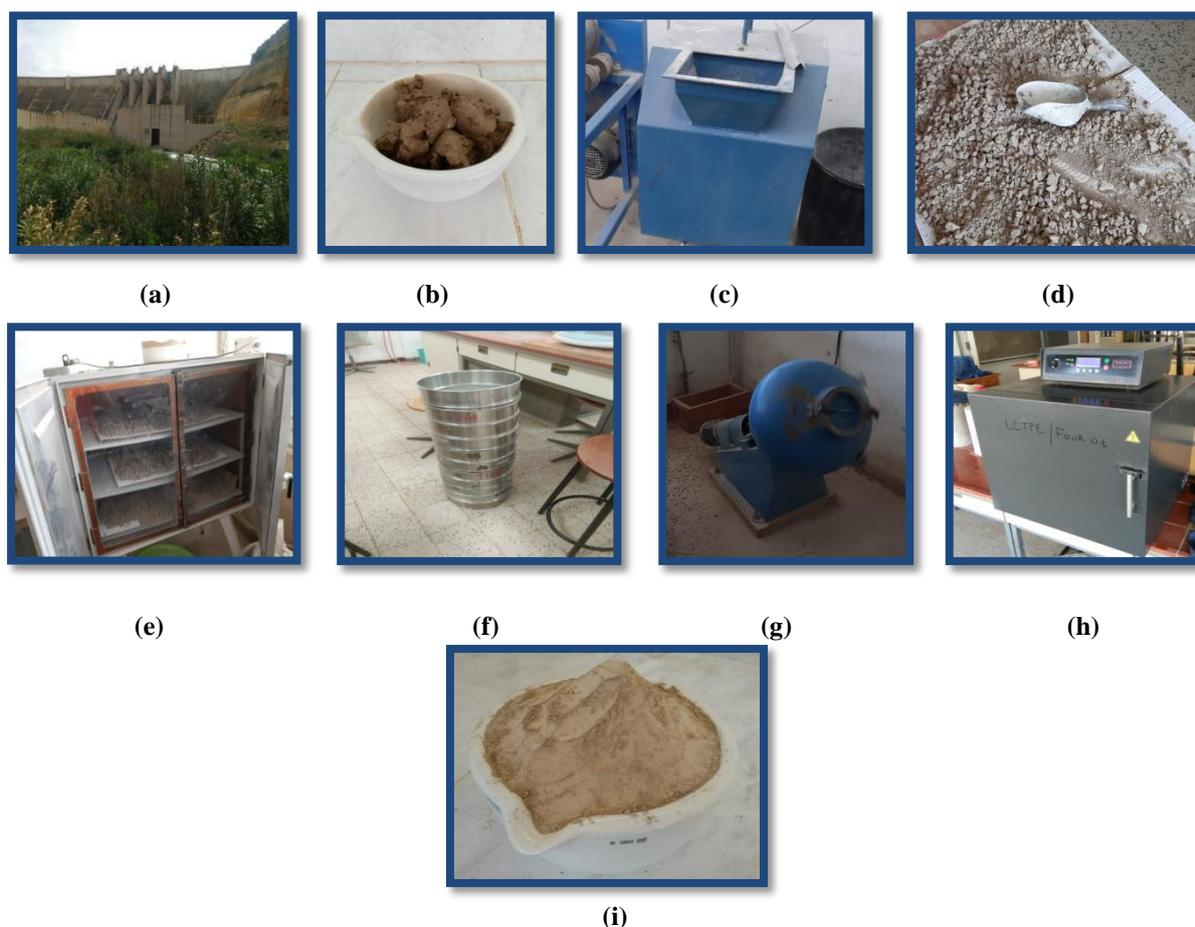
**Figure 4.5-** Etapes de préparation de la vase calcinée : Extraction (a), vase à l'état naturel (b), concasseur (c), vase calibrée (d), Etuve (e), Tamisage (f), Broyage (g), Calcination (h), Vase calcinée prête pour utilisation.
