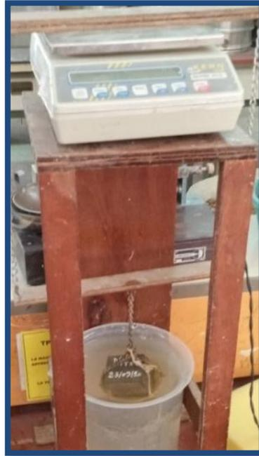
**Figure 5. 12-** Mesure de la masse des éprouvettes sous l'eau (Pesée hydrostatique).
