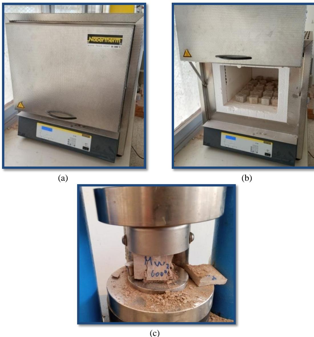
**Figure 5. 16-** Essai de résistance des mortiers aux hautes températures : Four Nobertherm (a), Mise en place des demi- éprouvettes prismatiques 40×40×80 mm dans le four (b), Essai de compression sur les demi éprouvettes 40×40×80 mm.
