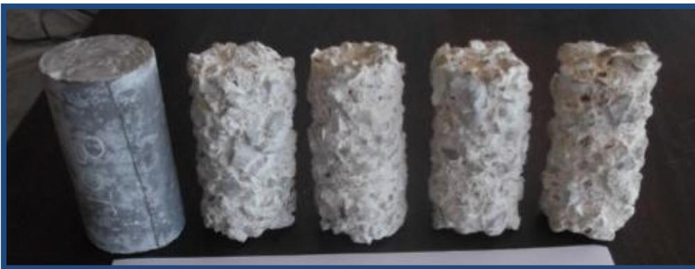
**Figure 2.46-** Echantillons de béton exposés en H<sub>2</sub>SO<sub>4</sub> 5% durant 12 semaines.
