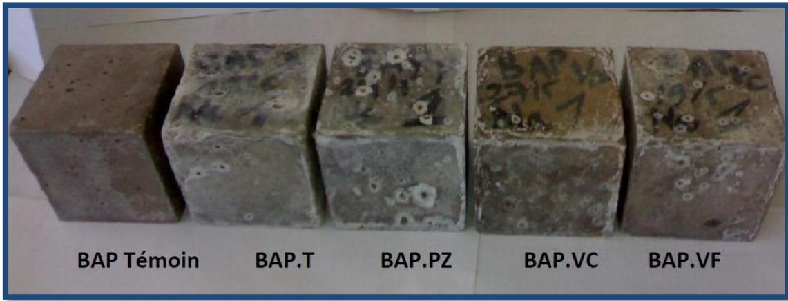
**Figure 2. 41-** Echantillons des différents bétons, après 360 jours d'immersion dans la solution de 5% de  $\text{Na}_2\text{SO}_4$  (Belaribi,O. 2015).
