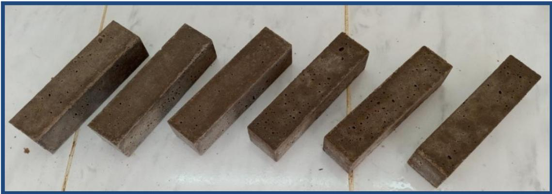
**Figure 5. 3-** Des éprouvettes de mortiers de forme prismatique  $40 \times 40 \times 160$  mm.
