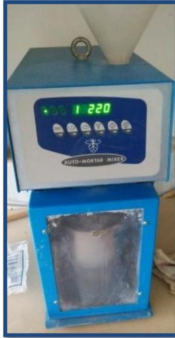
**Figure 5. 5-** Malaxeur de mortier CONTROLAB.
