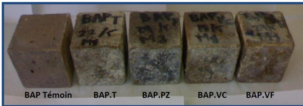
**Figure 2. 44-** Echantillons de différents bétons, après 360 jours d'immersion dans la solution de 5% de  $MgSO_4$  (Belaribi,O. 2015).
