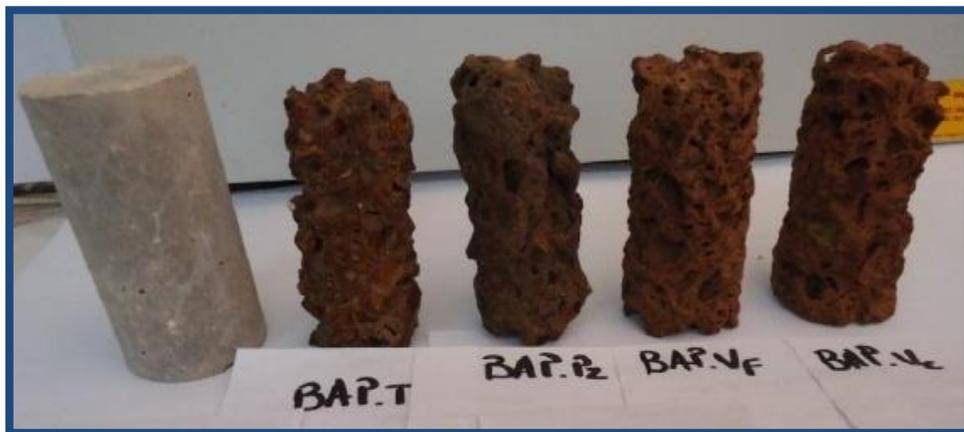
**Figure 2. 50-** Eprouvettes de BAP immergées 6 semaines en HCl 5% (Belaribi, O. 2015).
