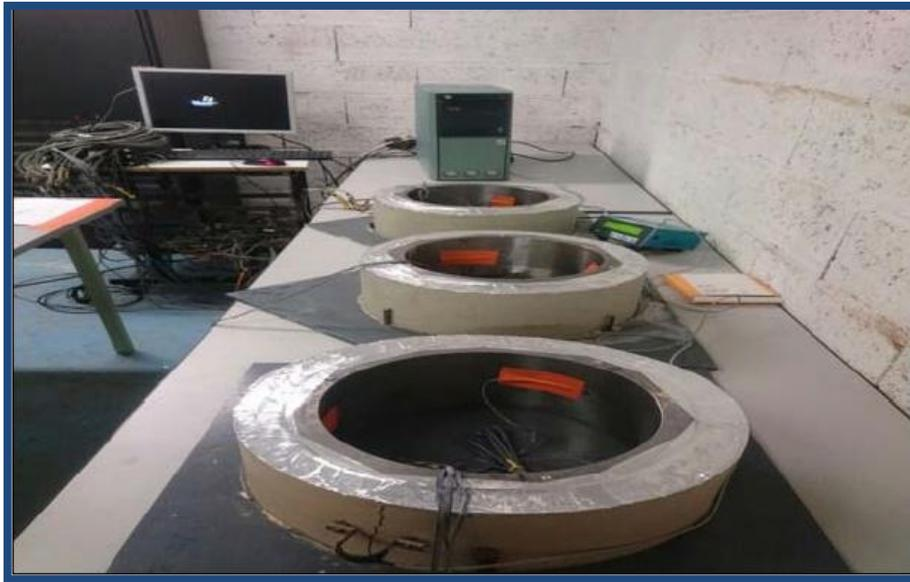
**Figure 2. 32-** Anneaux de mortier pour essai de retrait empêché (Taieb, F. 2019).
