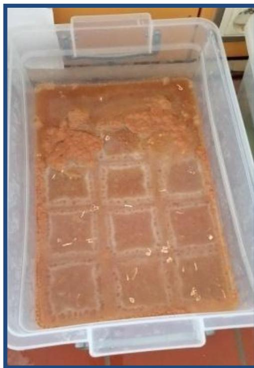
**Figure 5. 14-** Immersion des éprouvettes dans la solution acide HCl avec concentration 5%.
