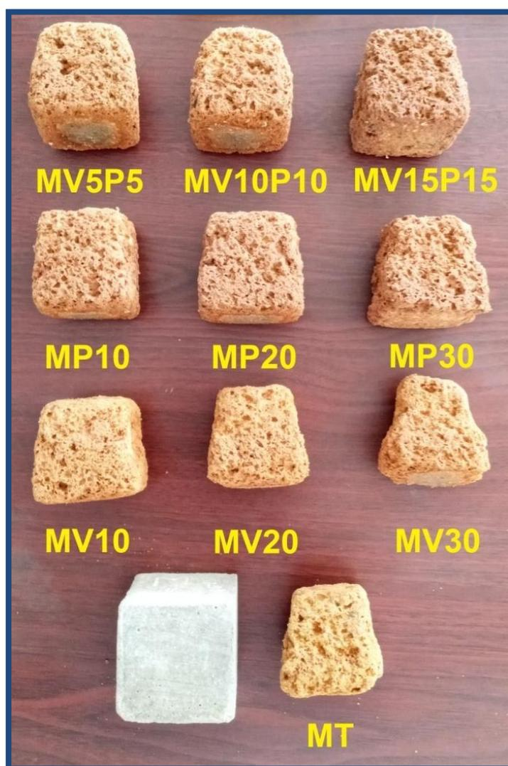
**Figure 6. 19-** Les dix mortiers après avoir exposé pendant 5 semaines dans l'acide chlorhydrique 5%.
