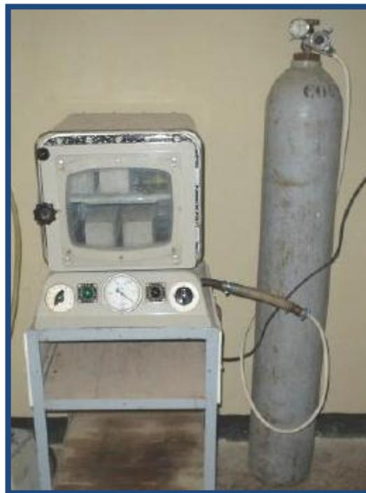
**Figure 2. 37-** Enceinte de carbonatation accélérée (Belaribi,O. 2015).
