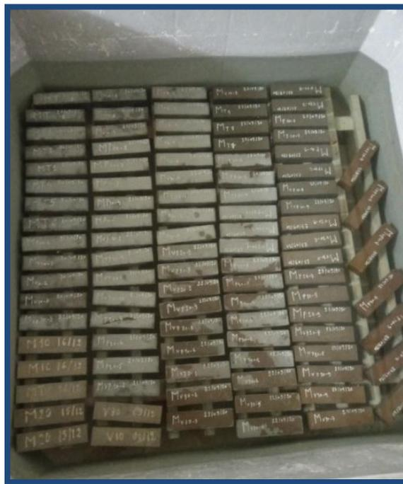
**Figure 5.8-** Cure à eau saturée en chaux.
