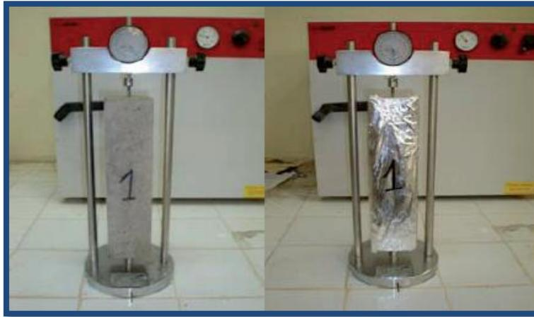
**Figure 2.28-** Des éprouvettes 7×7×28 mm pour les essais de variation des volumes (Belas,N. 2008).
