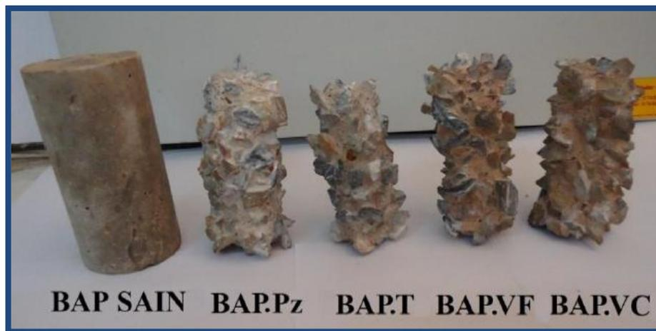
**Figure 2.48-** Epreuves de BAP immergées 6 semaines en  $H_2SO_4$  5% (Belaribi, O. 2015).
