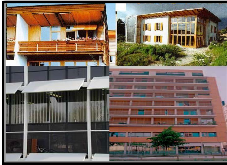
Figure 77 : les différents types de protections solaires. [ Crdp-monpellier.fr ]
