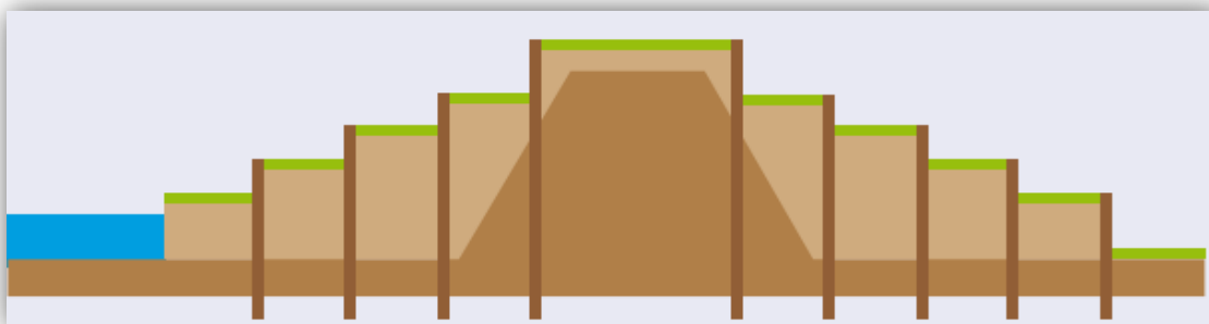
Figure 75: coupe schématique de la digue terrasse The H illedijk à Rotterdam.
