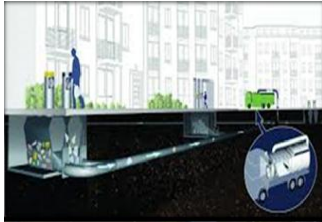
Figure 54 : le système de collecte pneumatique du fort d'Issy. (Institut national de l'économie circulaire ., 22 juin 2018)
