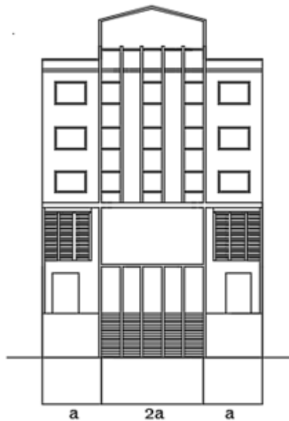
Figure 35. Les travées de la façade de l'immeuble d'habitation N° 2.
