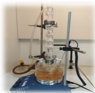
Figure III.1 : Montage à reflux utilisé pour le mélange réactionnel.
