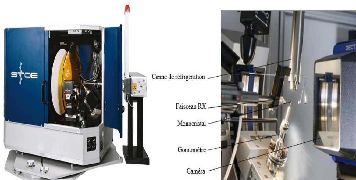
Figure III.3 : Dispositif expérimental d'un diffractomètre STOE IPDS 2.
