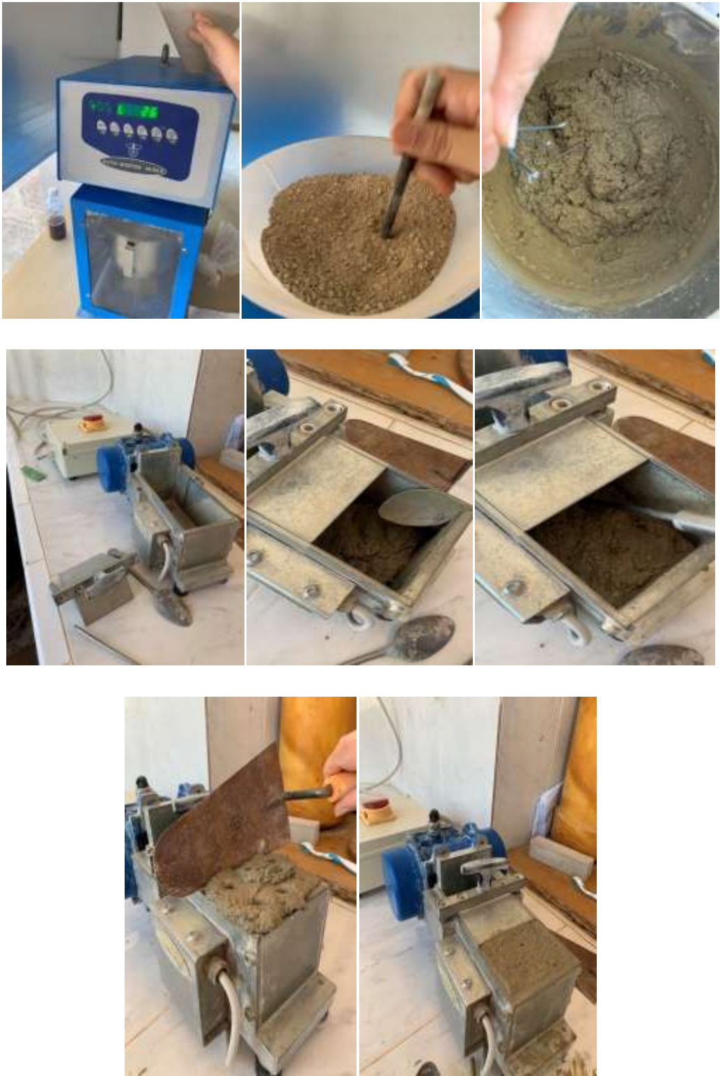
Figure II-14 : les étapes de l'essai de la maniabilité des mortiers
