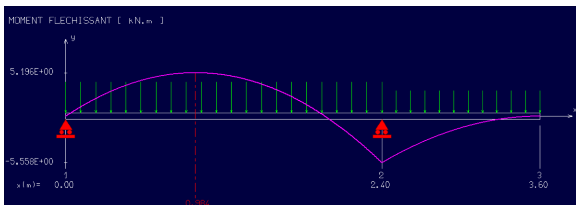
Figure IV.3.5: diagramme du moment fléchissant à l'ELS.
