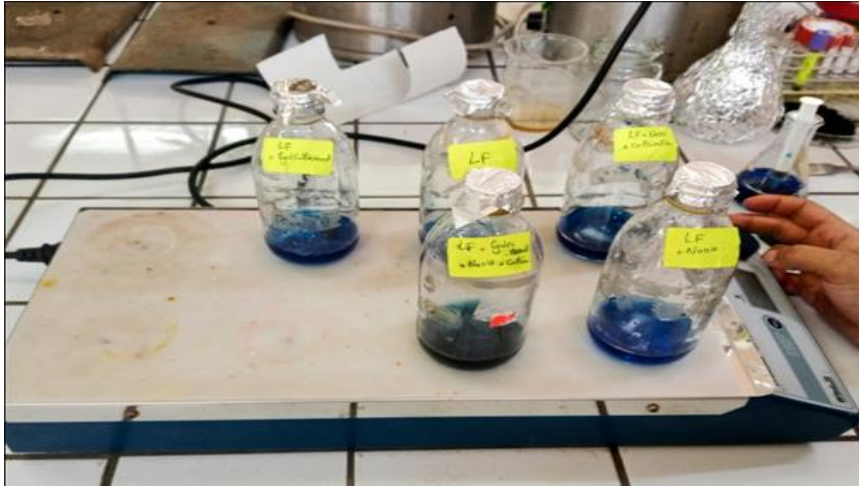
Figure 2. 9. L'Essai de l'adsorption du bleu de méthylène sur les différents adsorbants à une température ambiante (C=50ppm, V=20mL, m= 20mg, une vitesse de 300 rpm).
