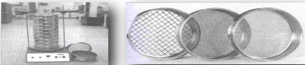
Figure VII.1 : Matériel utilisé dans l'essai granulométrique.
