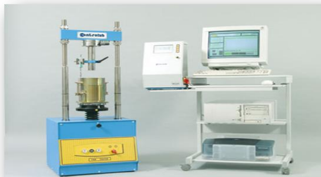
Figure VII 4 : Presse CBR avec système d'acquisition électronique.
