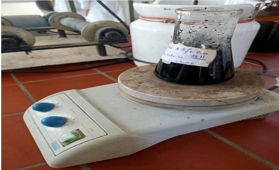
Figure II.2 : Agitation de CAP avec V ml d'eau
