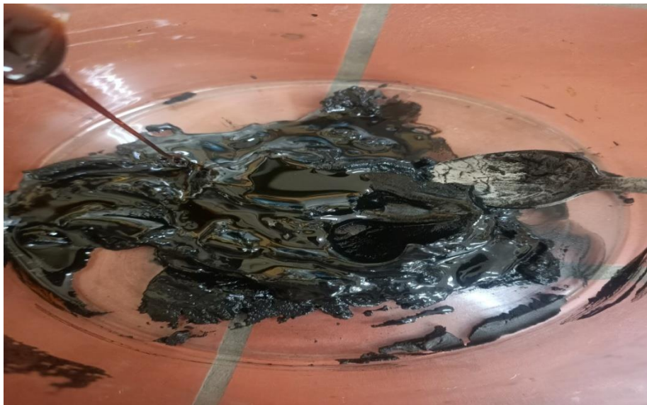
Figure II.5 : Mélange d'un charbon actif avec V ml de la mélasse
