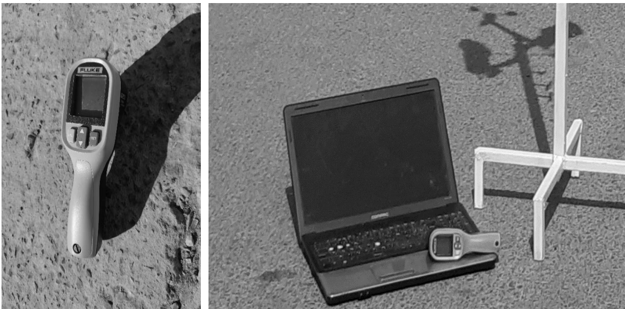
Figure 5.9: Thermomètre infrarouge de type FLUKE 59 MAX+ utilisé pour mesurer la température de surface lors de la campagne de mesure. Source : N. Bachir, 2020.
