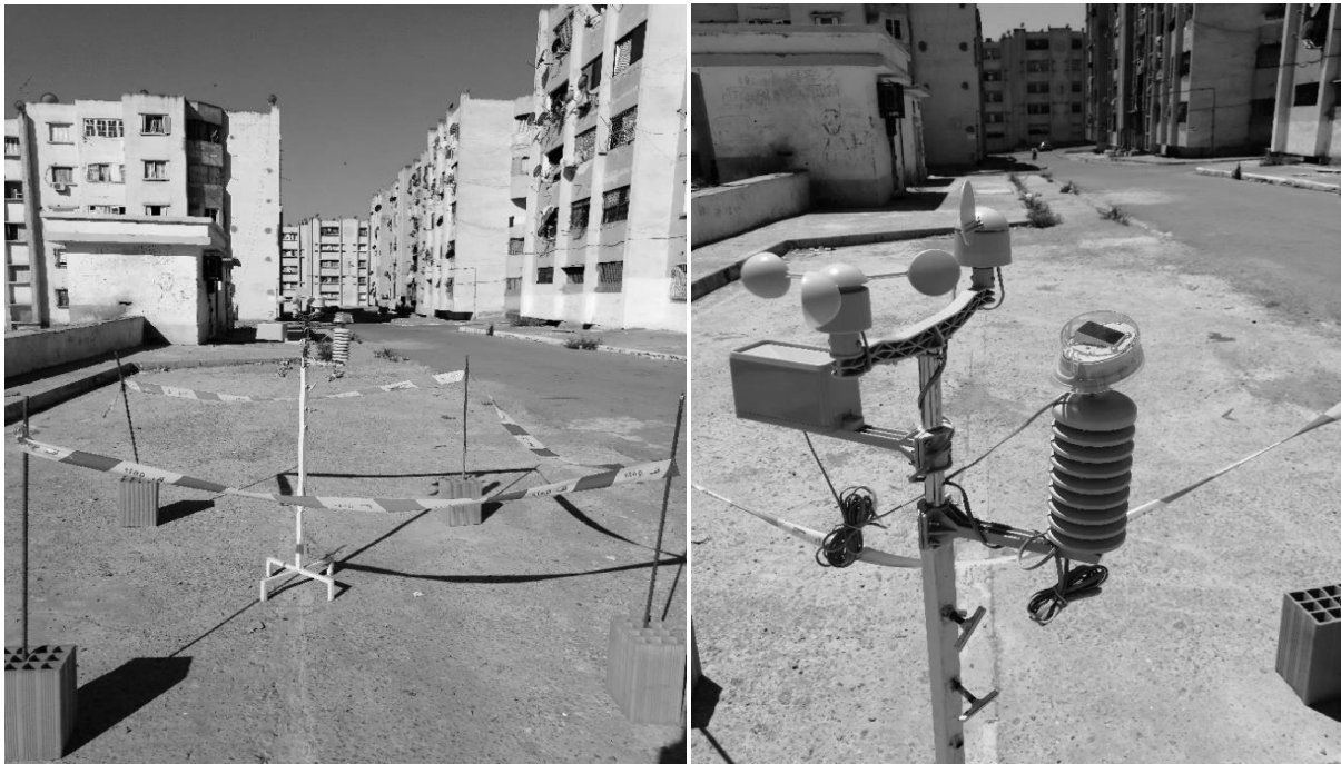
Figure 5.8 : La station météorologique du type PCE-FWS-20 utilisée lors de la campagne de mesure. Source : N. Bachir, 2020.
