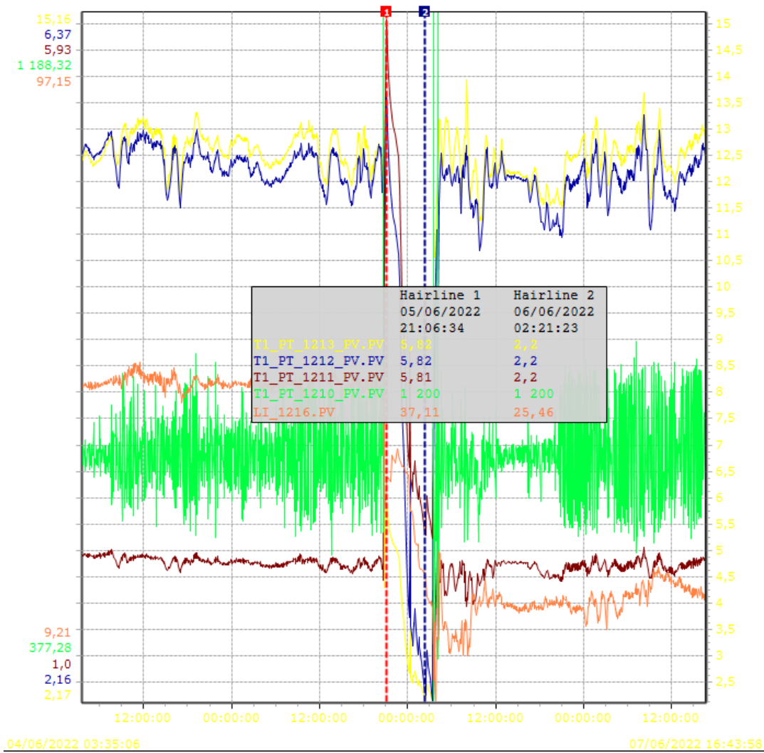
Figure III.2 : Les pressions des trois ballons et le refoulement des compresseurs après l'arrêt
