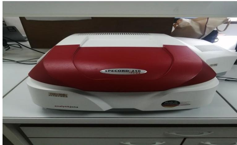
Figure II.2: spectrophotomètre UV-Visible
