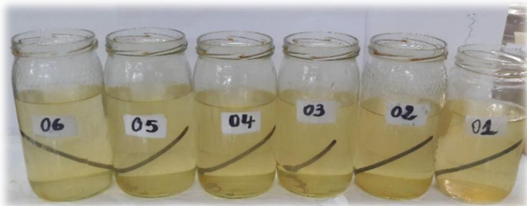
Figure N°19 : Corrosion de l'acier en fonction des ions de calcium (Cas des eaux dessalées)
