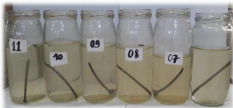
Figure N°19 : Corrosion de l'acier en fonction des ions de calcium (Cas des eaux dessalées)
