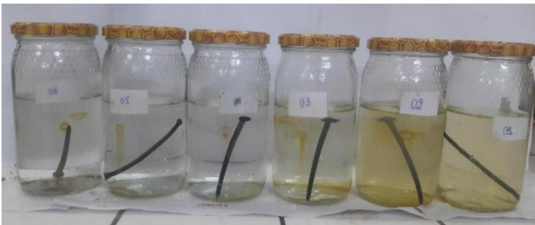
Figure N°13 : Corrosion du fer en fonction du pH (Cas des eaux dessalées)
