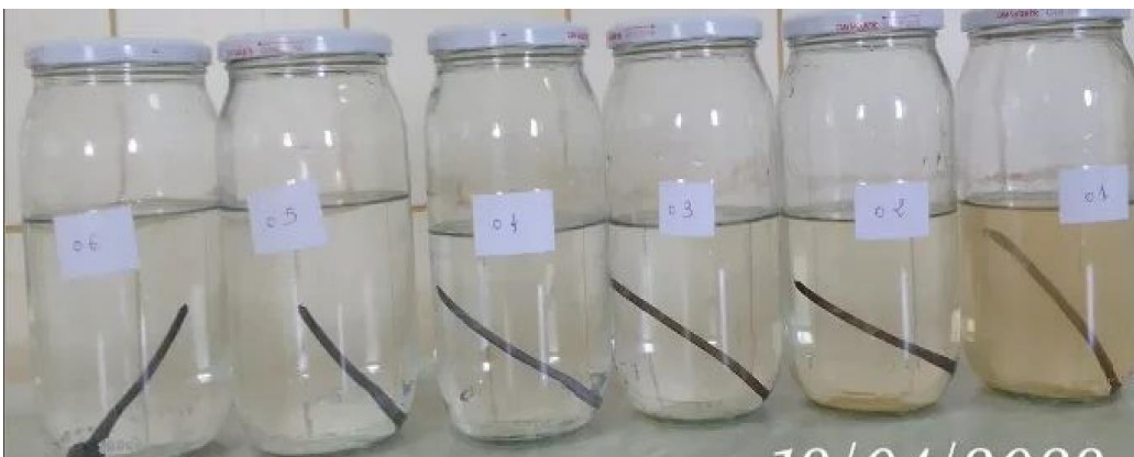
Figure N°14 : Corrosion du fer en fonction du pH (Cas des eaux de surfaces)
