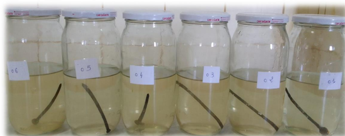
Figure N°17 : Corrosion du fer en fonction du TAC (Cas des eaux de surfaces)
