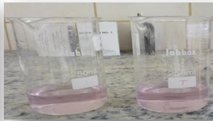
Figure II.3 : Ajout « solution tampon/NET ».
