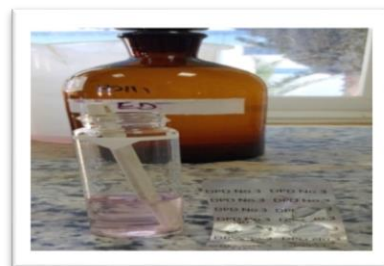
Figure II.19 : Mesure avec DPD1+DPD3 (Clt).
