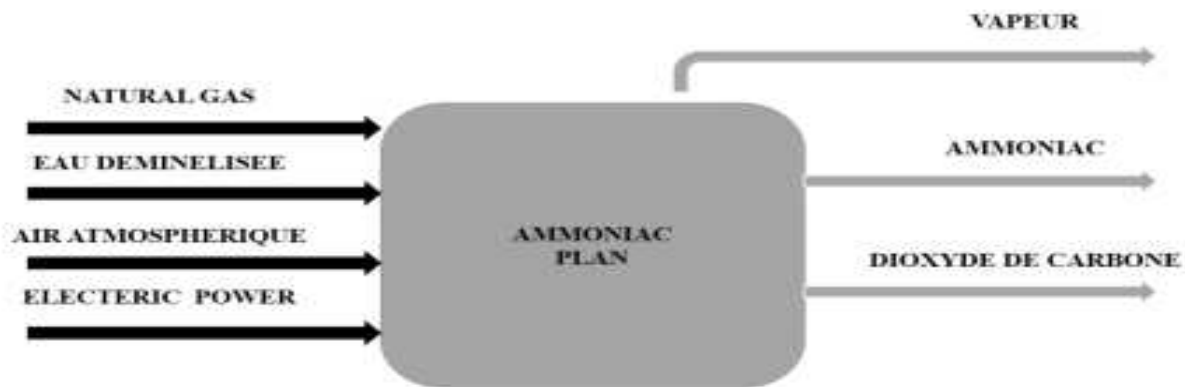
Figure I: Schéma de l'unité de l'ammoniac
