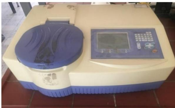
**Figure II. 12.** Photographie du spectrophotomètre UV-Visible (OPTIZEN 2120 UV)
