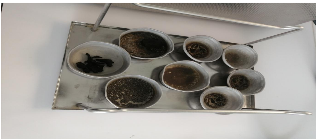
Figure III-11 : Les capsules après séchage par four à moufle
