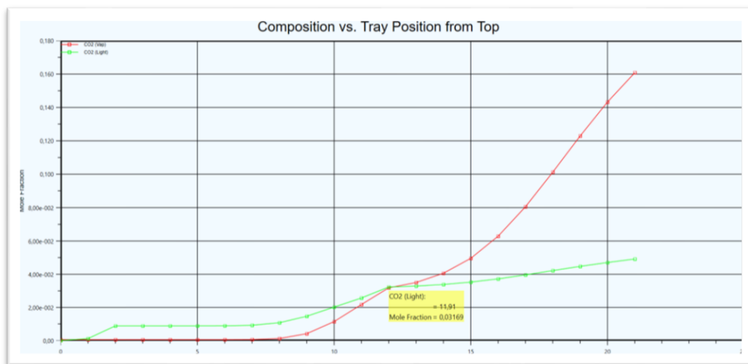
Figure II.12 : Profil de fraction molaire du CO 2 obtenu par Hysys du cas design de C001
