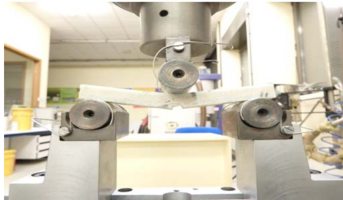
Figure II. 13. Déflexion des éprouvettes de grandes épaisseurs avec entaille [15].
