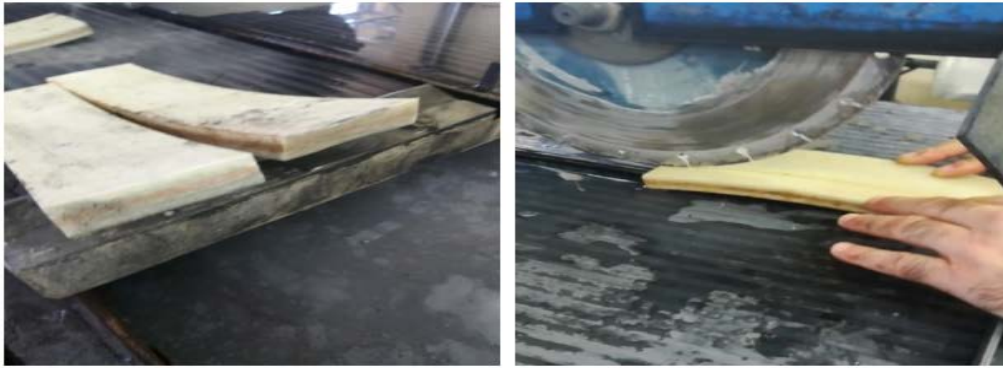
Figure II. 2. Découpage des échantillons à partir du pipe en sandwich[15]
