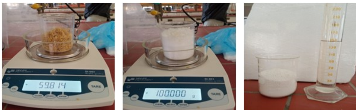
Figure 3.3 : La préparation des différents matériaux nécessaires à la formulation (plâtre, MCP et eau).
