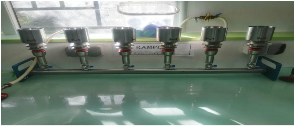
Figure III.5 : photo de rampe de filtration
