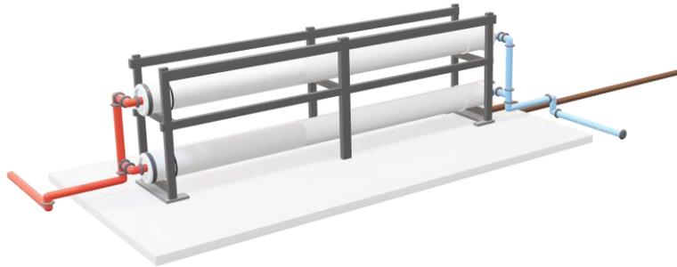
**Figure 33 :** Représentation schématique en 3D du nouveau pilote (2<sup>ème</sup> pilote) d'osmose inverse.
