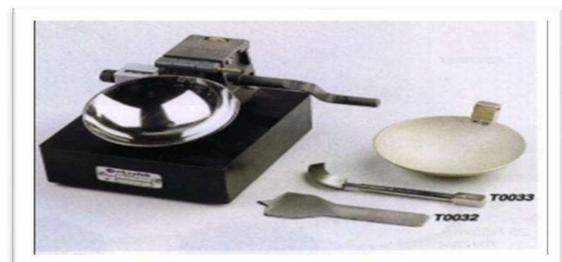
FIG VIII-2 : Appareil De Limites d'Atterberg
