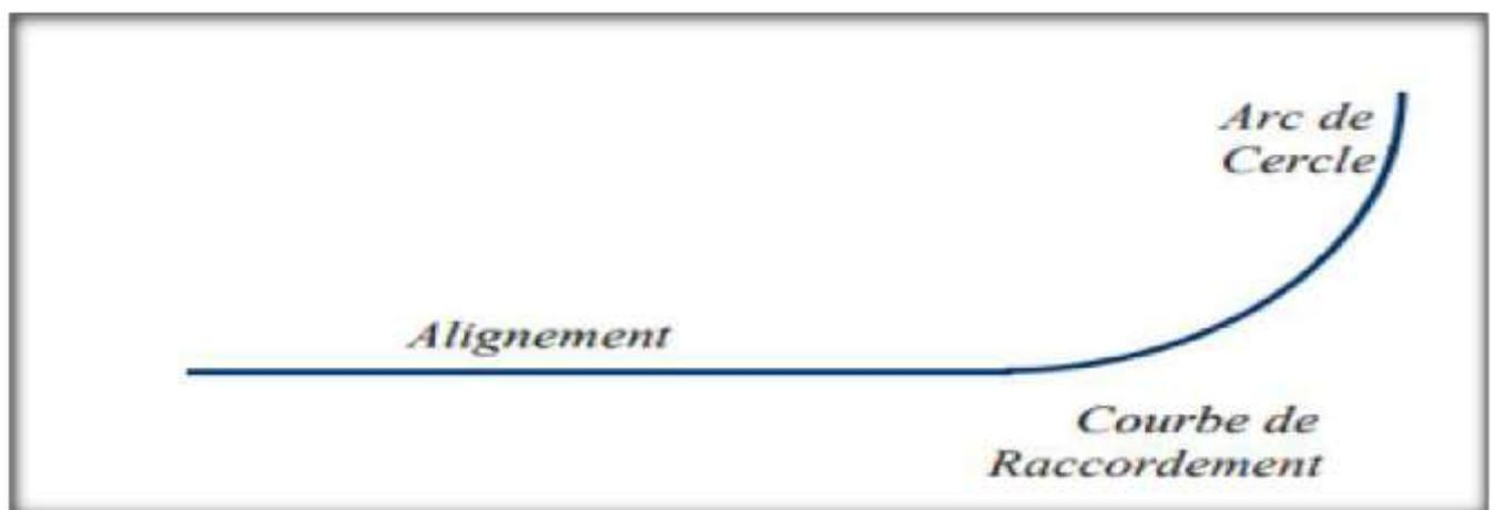
Figure IV.1 : Les éléments du tracé en plan
