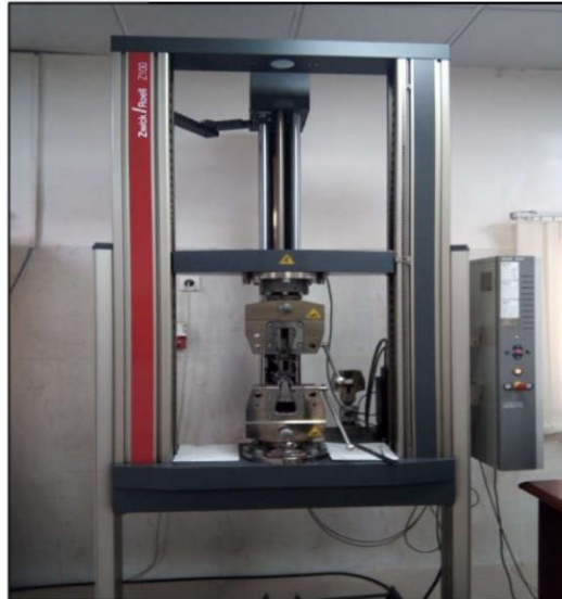
Figure III.7 : Machine de traction 100 KN du GISB.
