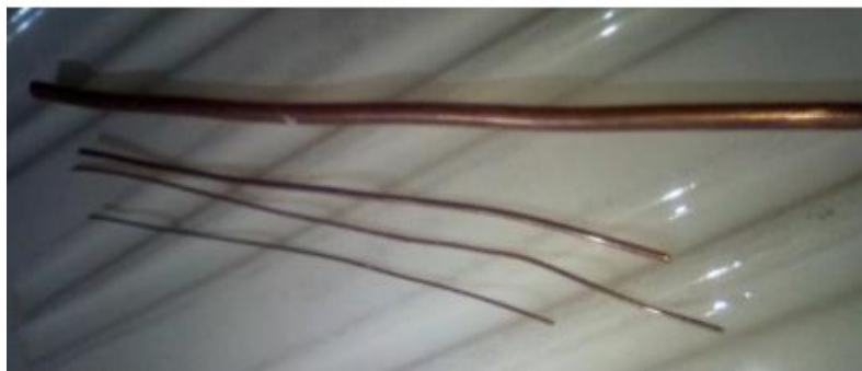
Figure III.6 : Fil machine 8mm et fils tréfilés de cuivre étudiés.
