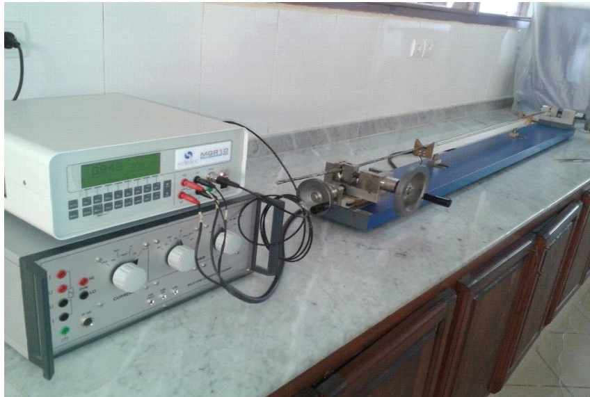
Figure II.11. Mesure de la résistance d'un câble
