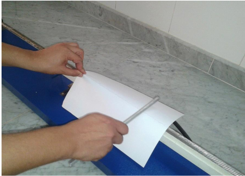
Figure II.9. Mesure du pas d'un câble.
