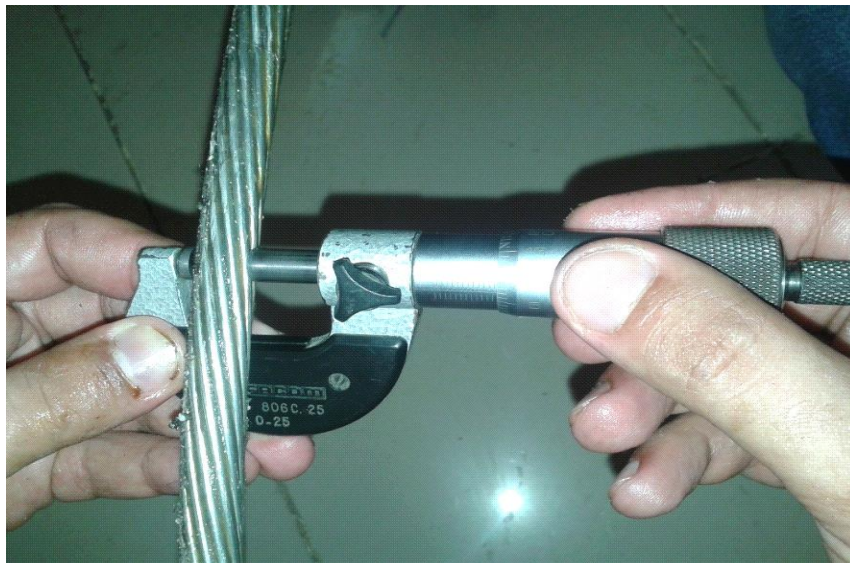
Figure II.10. Mesure du diamètre d'un câble
