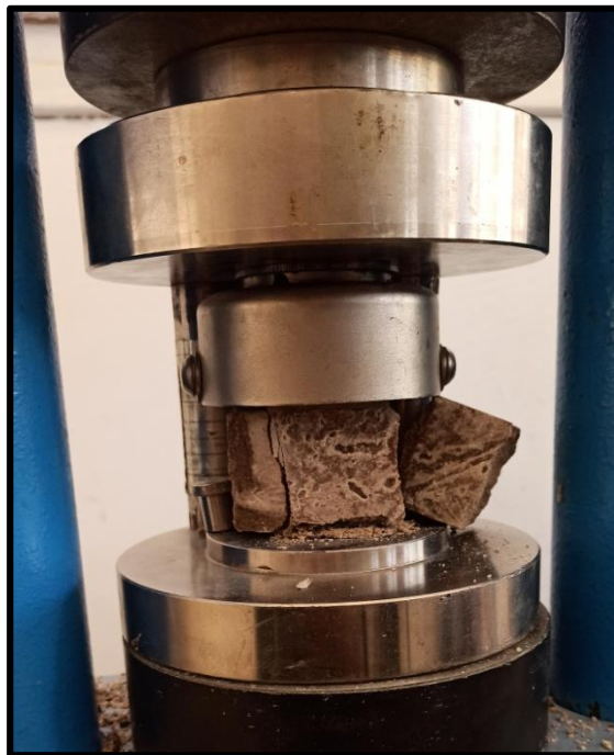
Figure III- 7: Essai de la résistance à la compression
