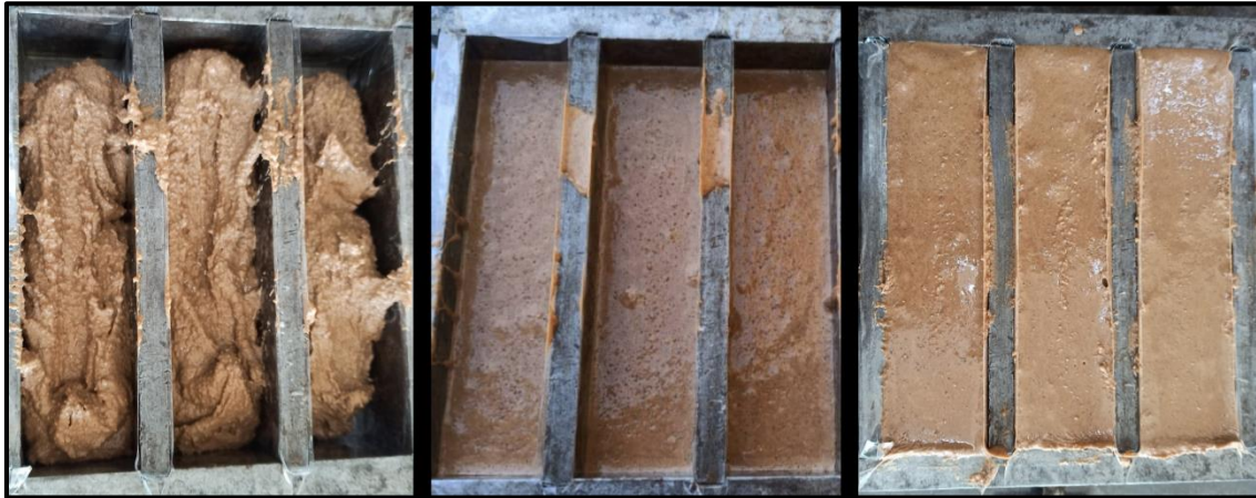
Figure III- 4:Les moules prismatiques lors de remplissage de la pate géopolymère
