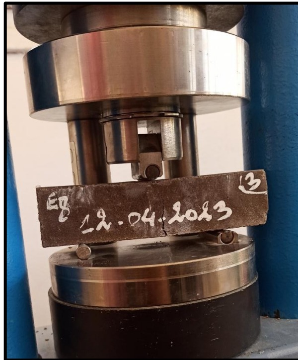
Figure III- 6:Essai de traction par flexion
