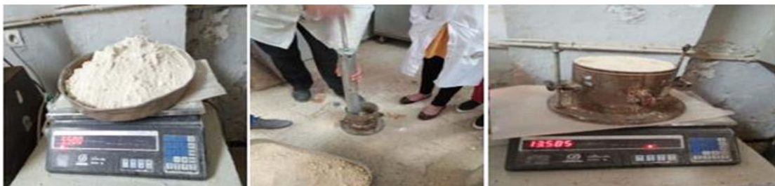
Figure 0-24 Les étapes de l'essai Proctor.
