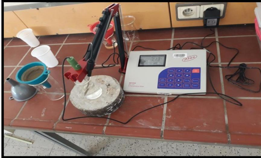
**Figure III.17.** La mesure du pH du sol.
