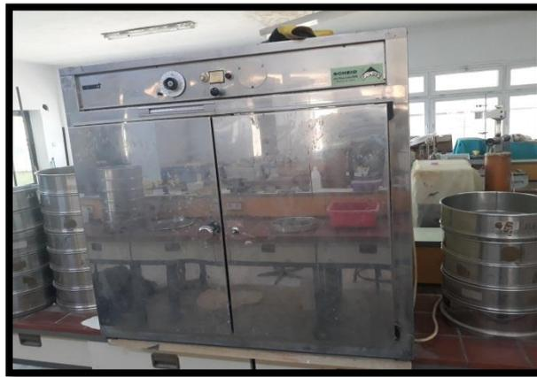
**Figure III .14.** Séchage des échantillons du sol à l'étuve.
