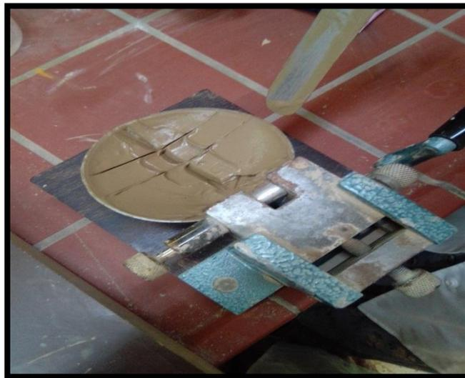
**Figure III.5.** L'appareil de Casagrande pour la détermination de la limite de liquidité.
