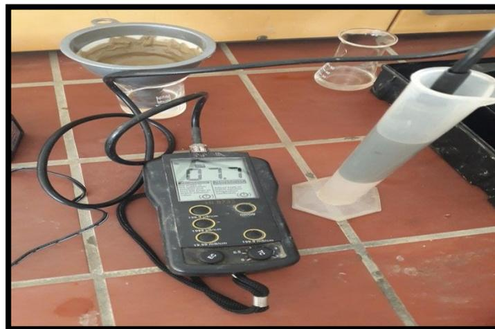
**Figure III.18.** Mesure de la conductivité électrique du sol.
