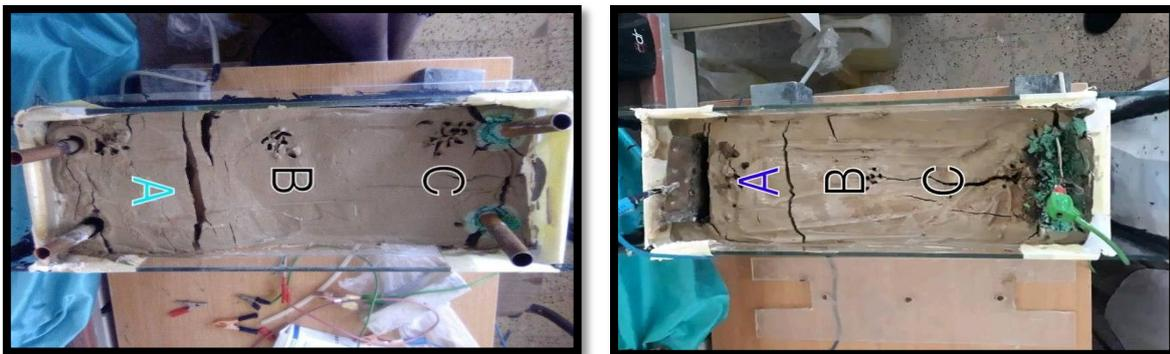
**Figure IV.10.A)** Fissuration des échantillons de sol côté cathode avec plaque cuivre (EPL) et tube cuivre (ET), **B)** Trace d'eau (partie superficielle), **C)** Fissuration des échantillons de sol côté anode avec plaque cuivre et tube cuivre
