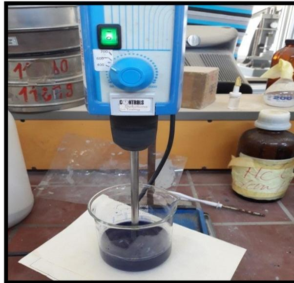
Figure III.15. La réalisation de l'essai au bleu de méthylène.
