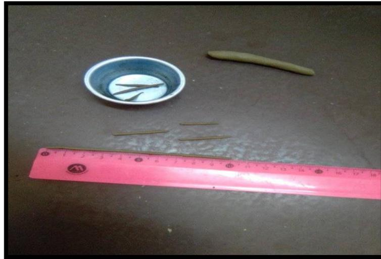
**Figure III.8.** Essai de détermination de La limite de plasticité ( $W_P$ ) des échantillons de sol au laboratoire.
