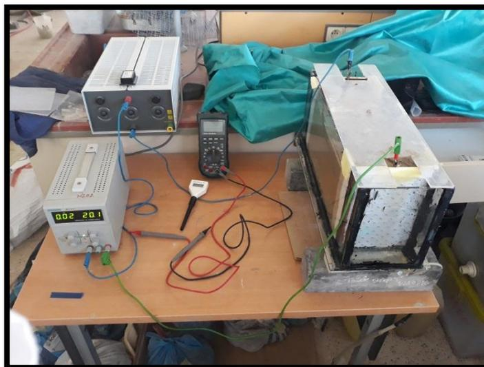
**Figure IV.2.** Dispositif expérimental de la cellule électrocinétique avec des électrodes en Plaques de cuivre.
