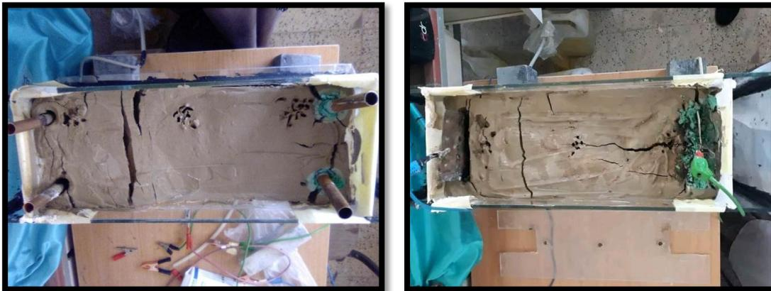
Figure IV.12. Fissuration du sol ET et EPL après 7 jours.
