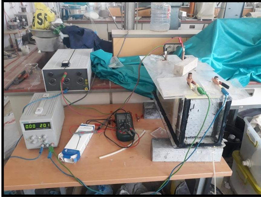
**Figure IV.3.** Dispositif expérimental de la cellule électrocinétique avec des électrodes en tubes de cuivre.
