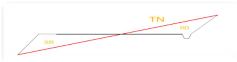
Figure 01 : Les positions des sections dans un profil en long d'un tracé donné
