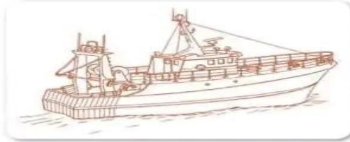
Petit chalutier pêche arrière de taille moyenne Longueur hors tout 20m سفينة جياب صغيرة بالجزء الخلفي متوسطة الحجم
