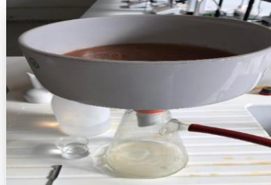
Figure 22 : Filtration sous vide
