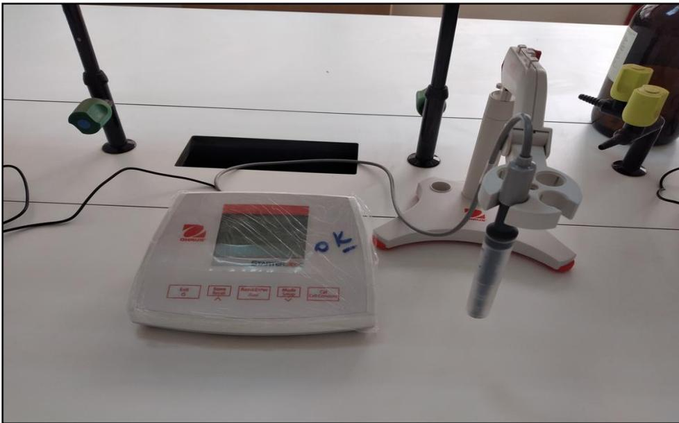
**Figure II.6 : La conductimètre**
