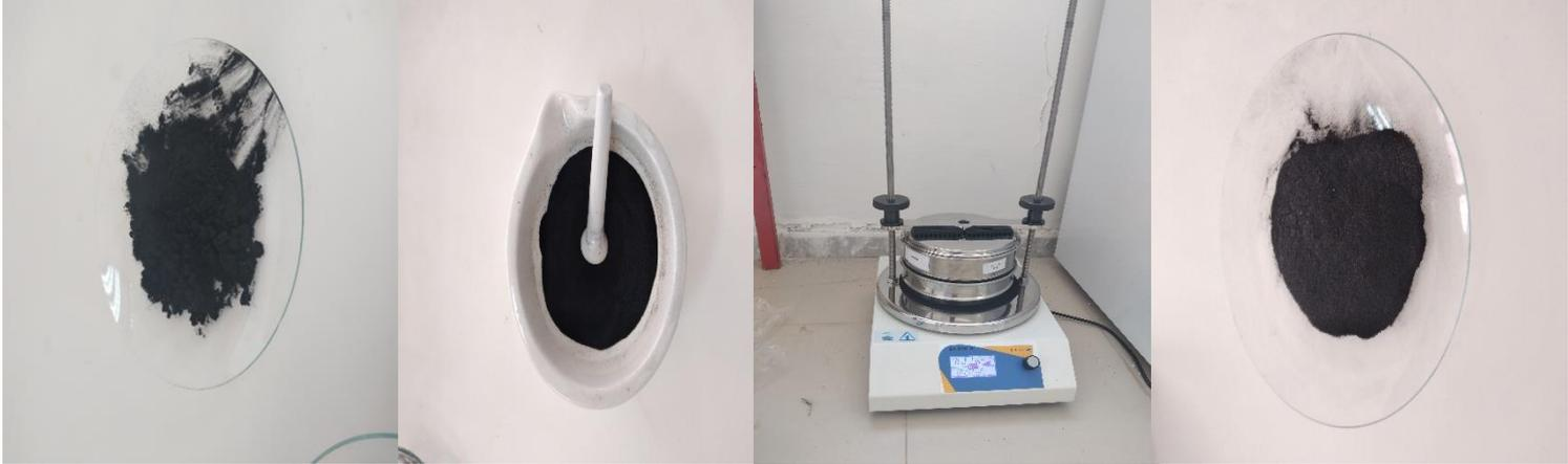
**Figure IV.3 : tamiseuse, mortier avec son pilon et le charbon actif**
