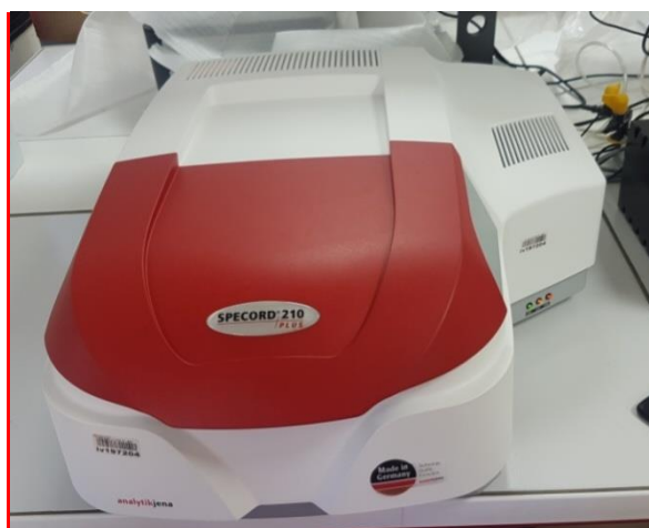
Figure II.4. Spectrophotomètre UV-Visible utilisé pour mesurer l'absorbance.
