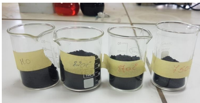
Figure II.2. Charbon activé thermiquement à des différentes températures.
