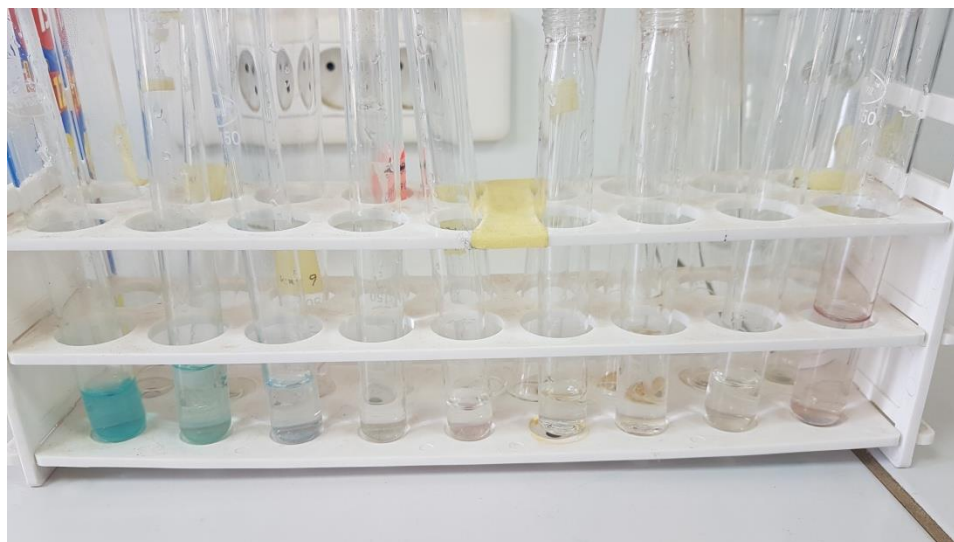
Figure III.8. Perméances des solutions du VM de concentration de 10^{-5} M et 10^{-4} M traité par le charbon activé à 750°C.
