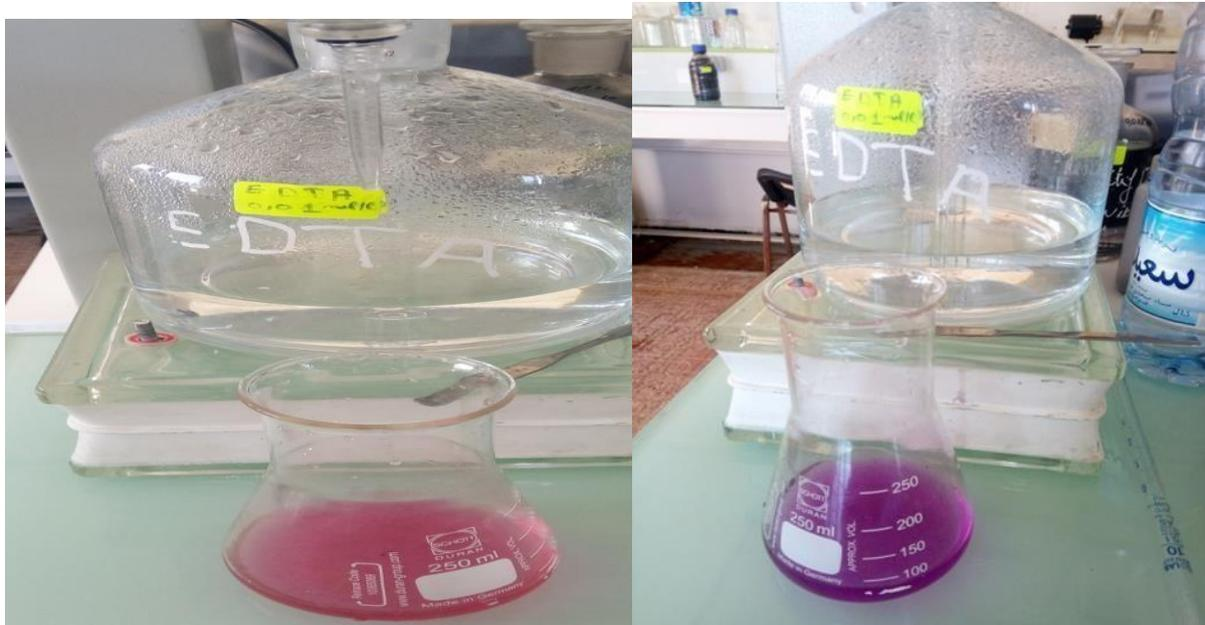
**Figure 8 : Changement de couleur de l'échantillon pendant l'étalonnage**
