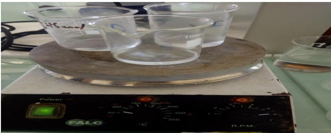
Figure 12 : Séchage des solutions sur une plaque chauffante
