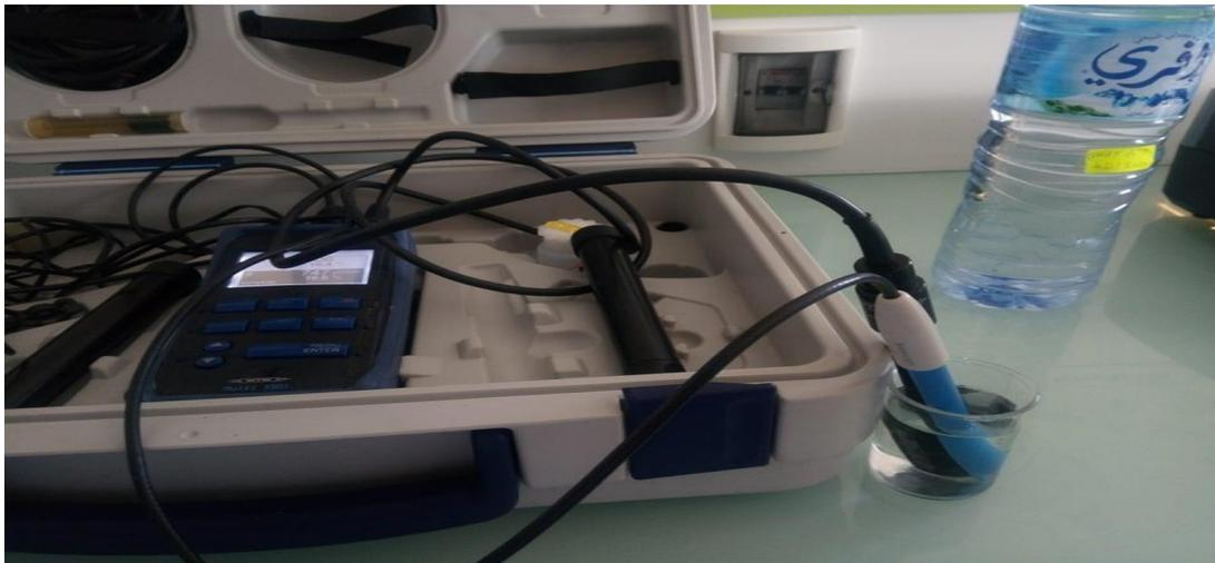
**Figure 6 : Appareil de multi-paramètres wtw.**
