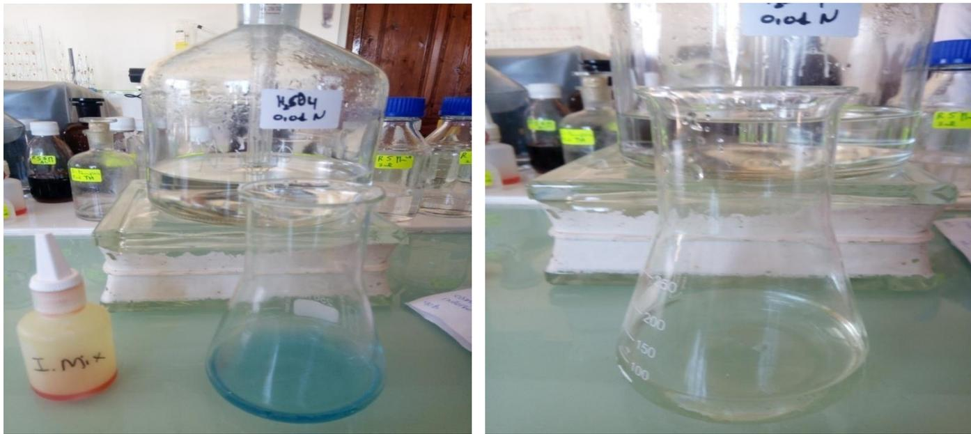
**Figure 9 : Changement de couleur de l'échantillon pendant l'étalonnage**
