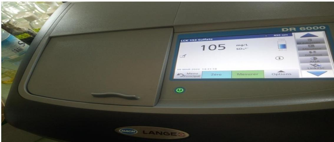
Figure 13 : Spectrophotomètre UV-VIS DR6000 hach
