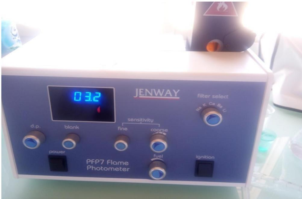
Figure 11 : Spectromètre de flamme jenway.
