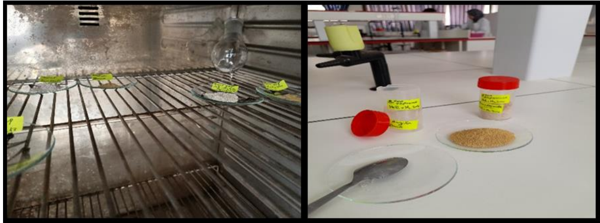
Figure III.7. Récupération les deux échantillons d'argile activées et séchés dans Une étuve à 50 °C puis finement broyée
