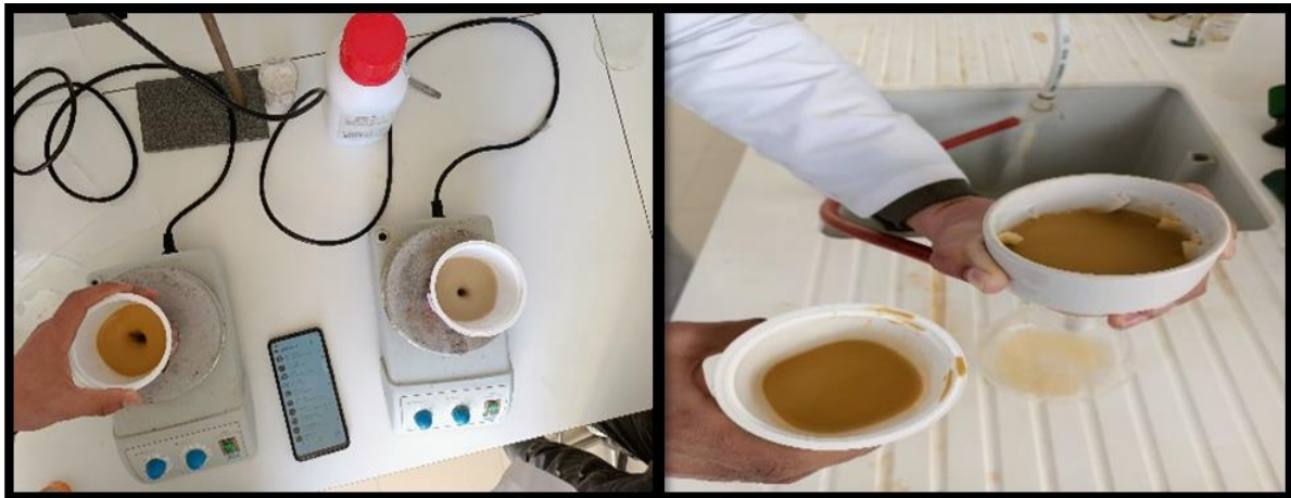
Figure III.6 Agitation de l'argile saturée au NaCl en présence des acides HCl et H 2 SO 4 puis on filtre les mélanges d'argile.
