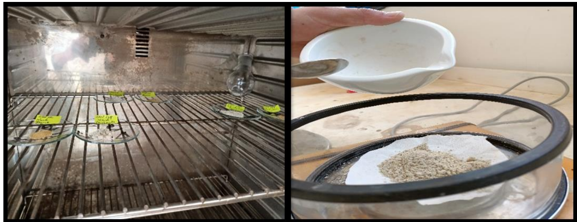
Figure III.4. Récupération les deux échantillons d'argile et séchés dans une étuve à 50 °C Puis finement broyée.
