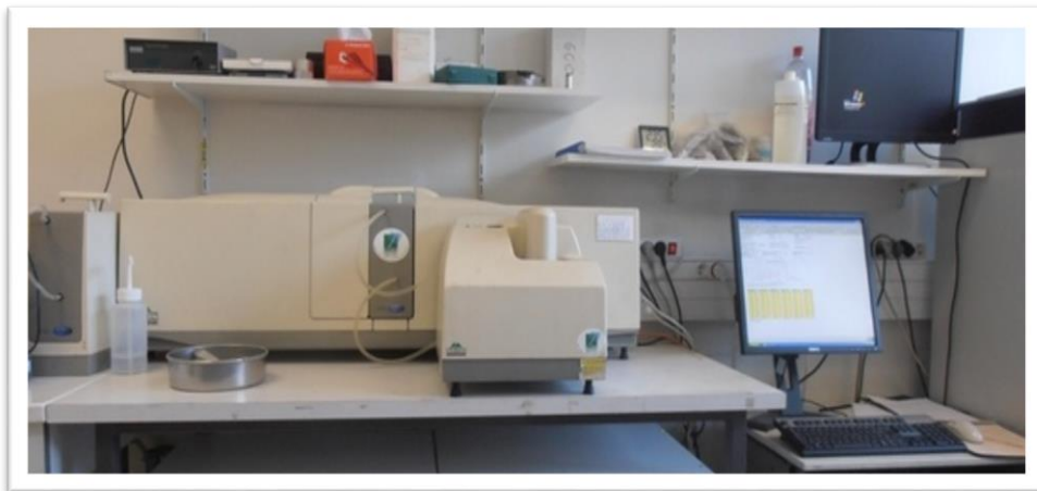
Figure II.3: l'unité optique d'une granulométrie laser. [10]
