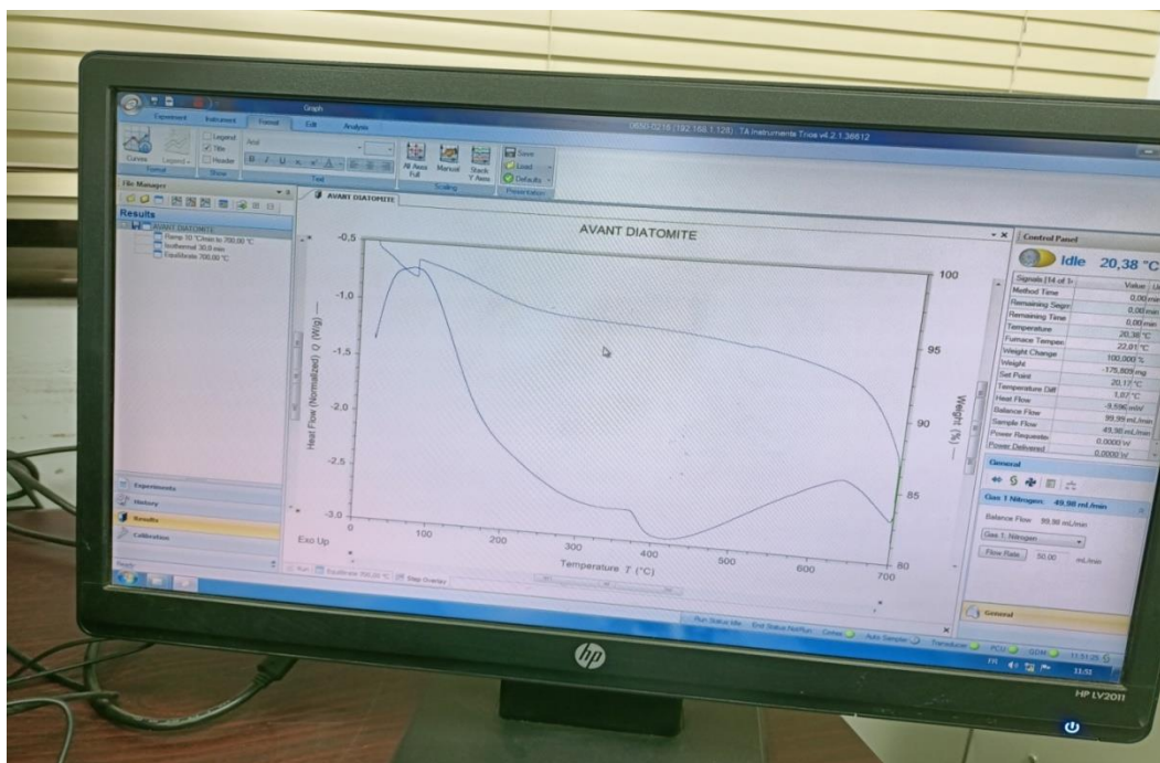
Figure III.19: Courbes thermogravimétriques et différentielle diatomite.
