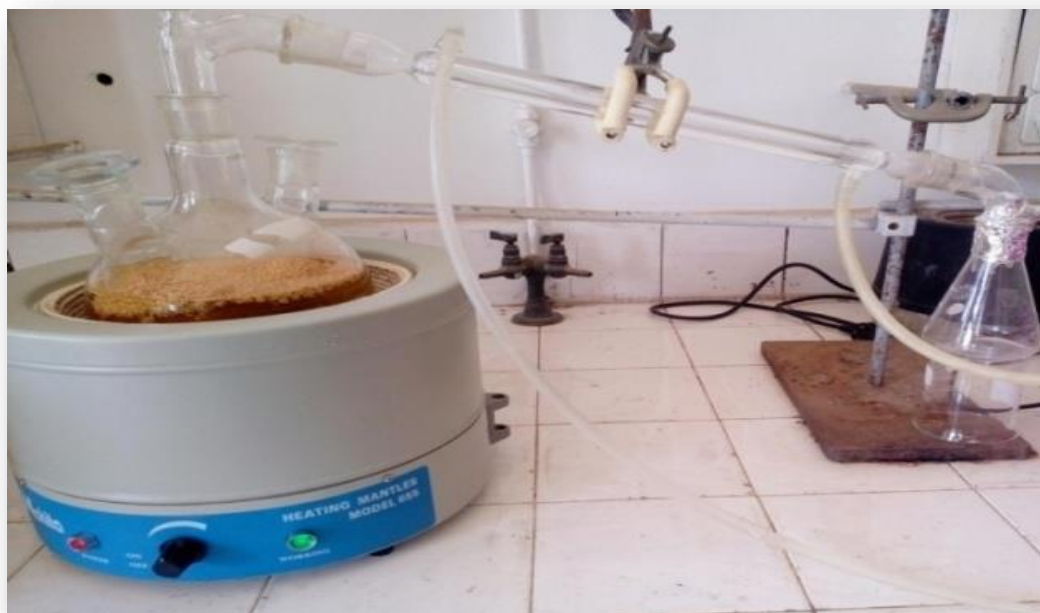
Figure 18 : Montage de l'hydro distillation
