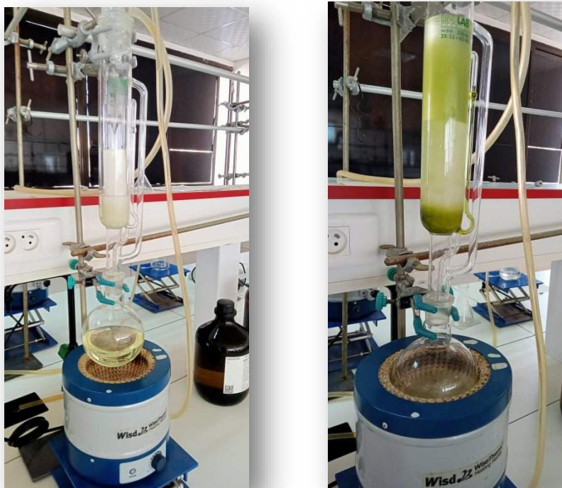
Figure 27 : Le montage d'extraction (Soxhlet)
