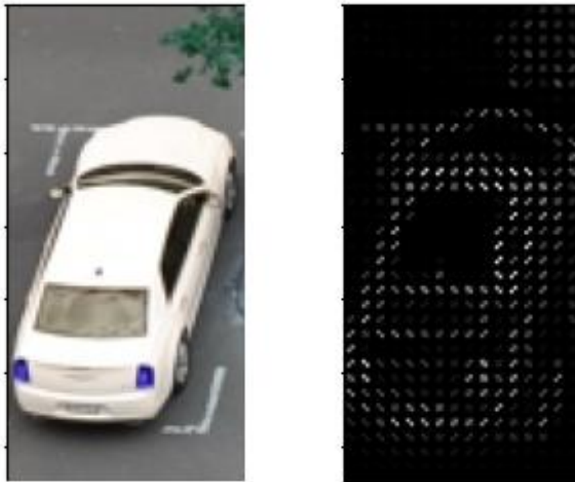
Figure 22: Extraction des caractéristiques par le HOG (cellule=4x4) pour une place occupée
