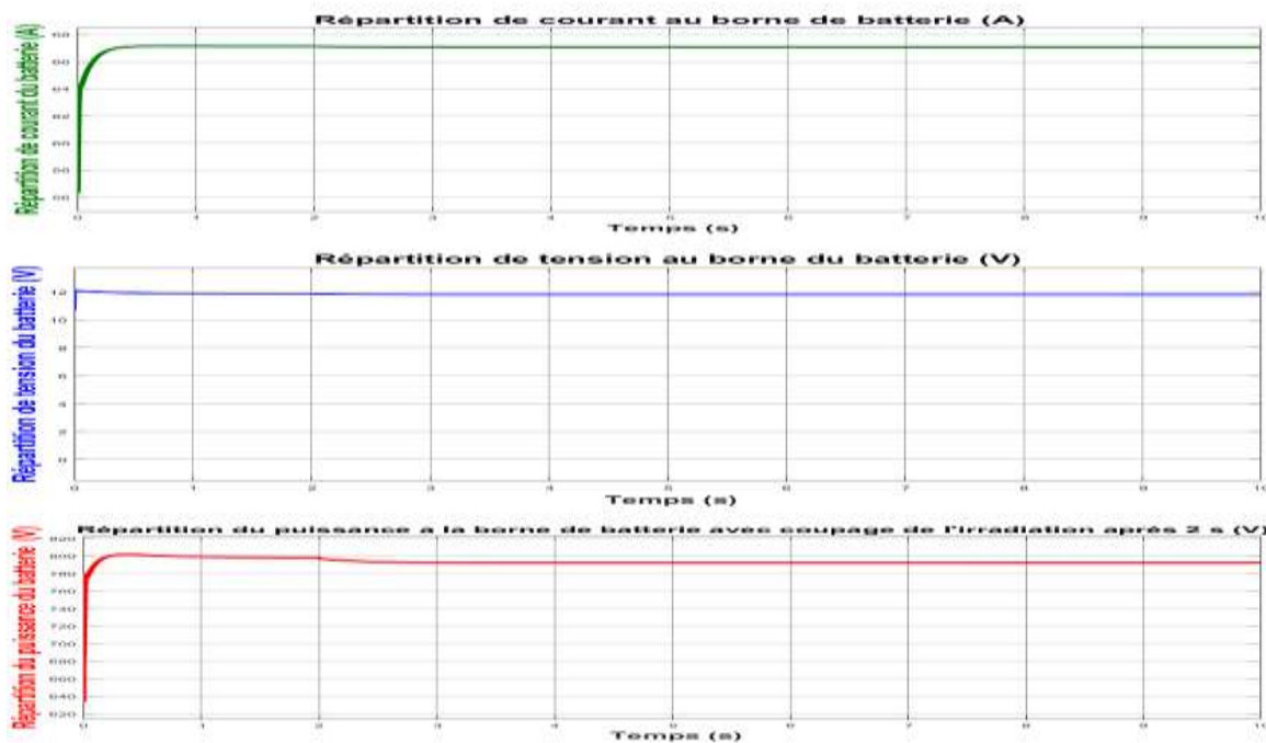
Figure 3.19 : Résultats de simulation de répartition de Batterie avec une coupure Ir après 2 s.
