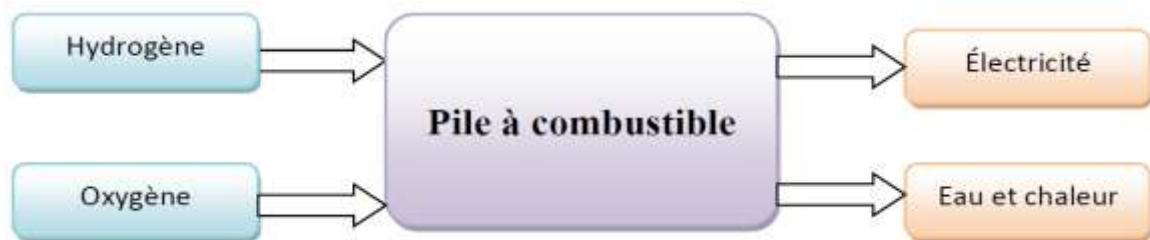
Figure 2.3 : Schéma de principe de conversion directe en électricité [20]
