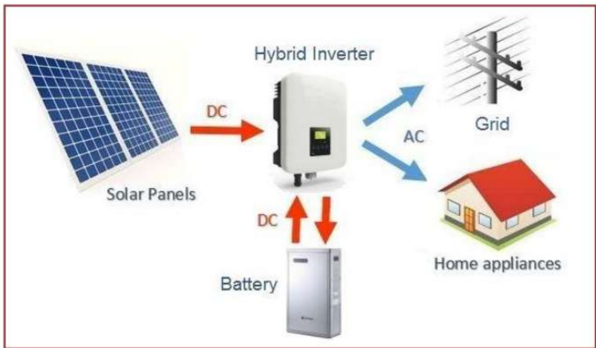
Figure 1.1 : Système solaire hybride [1].
