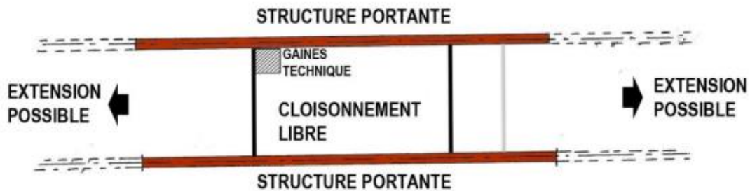
Figure 50 la flexibilité éléments porteurs( mure porteurs) ( plan) source Architecture bazeed Architecture évolutive / flexible XB Architectes - Version 1 – 16/11/2015
